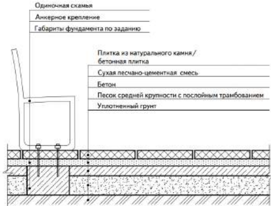
Илл. 5.1.1. ПРИНЦИПИАЛЬНАЯ СХЕМА МОНТАЖА СКАМЬИ В МОЩЕНИЕ
