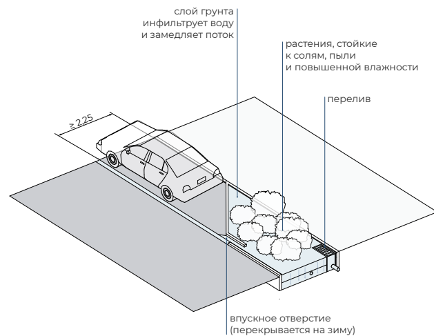
БИОДРЕНАЖНАЯ КАНАВА НА ИСКУССТВЕННЫХ СУЖЕНИЯХ ПРОЕЗЖЕЙ ЧАСТИ
