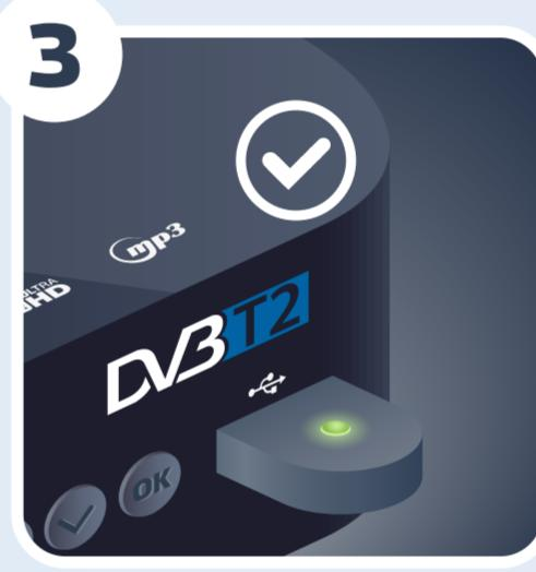
Подключаем флешку к приемнику и ждем сообщения на экране ТВ о том, что внешний накопитель подключен и распознан приемником
